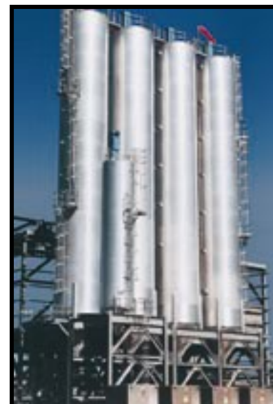
Silos de aluminio soldados en taller
